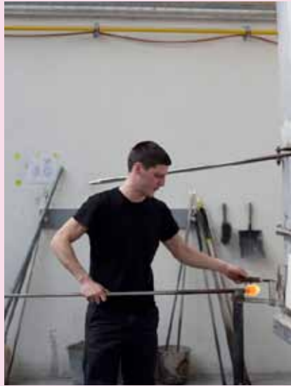
1 Das Glas ist ein kleiner glühender Klumpen, der an einem langen „Blas-Rohr“ hängt.
