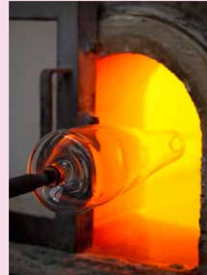
9 Das Glas wird ein weiteres Mal erhitzt.
