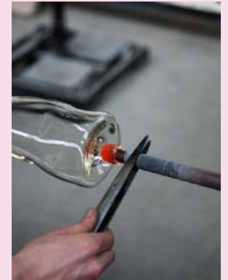
8 Eine Stange wird am Boden des Gefäßes befestigt, während das „Blas-Rohr“ entfernt wird.
