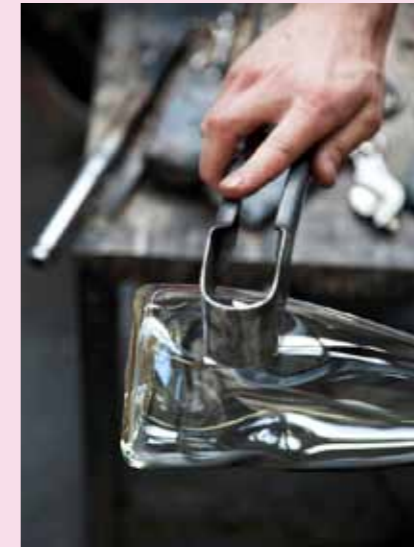
7 Mit dem hinteren Ende der Zange werden Dellen ins heiße Glas gemacht.
