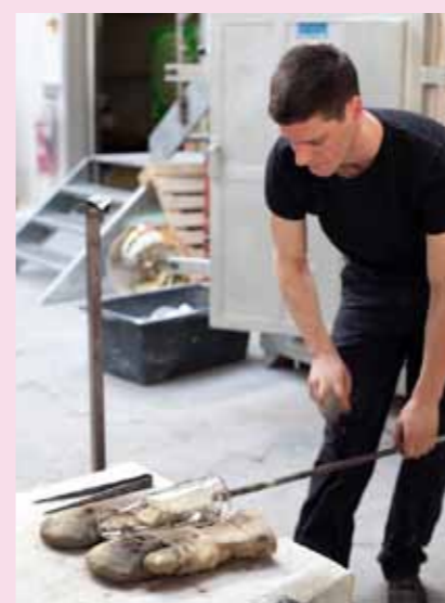
11 Die Karaffe wird von der Stange gelöst.
