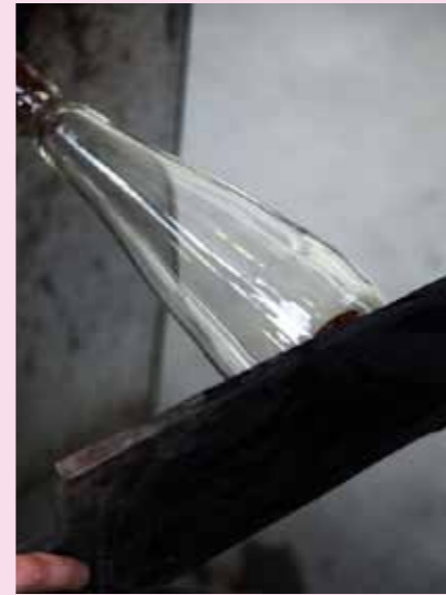
6 Der Boden wird mit einem Holzspachtel angedrückt.
