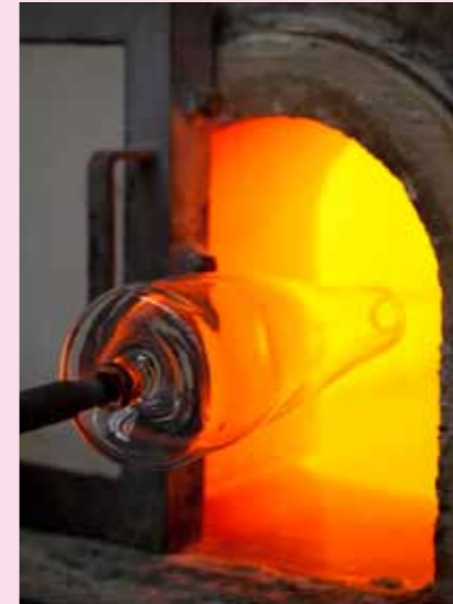
9 Das Glas wird ein weiteres Mal erhitzt.
