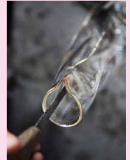
... und Zange werden Hals und Ausguss geformt.
