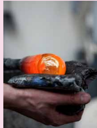
... und durch Drehen über einen Papierlappen wird es in eine erste Form gebracht.
