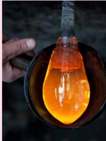
2 In einer mit Wasser gefüllten Holzform ...
