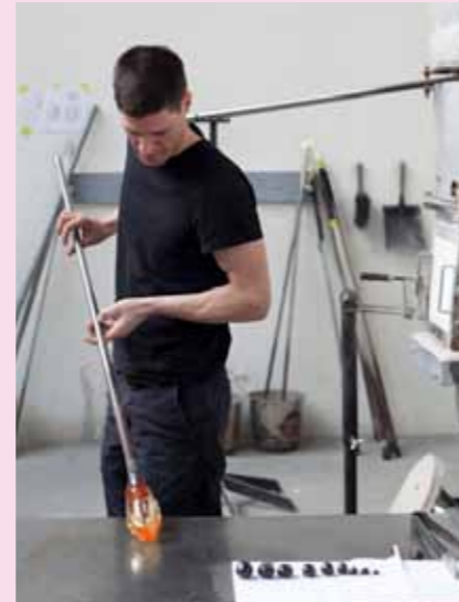
4 Nach mehrmaligem Erhitzen, Blasen und Drehen formt Matteo das Material auf der Tischfläche.
