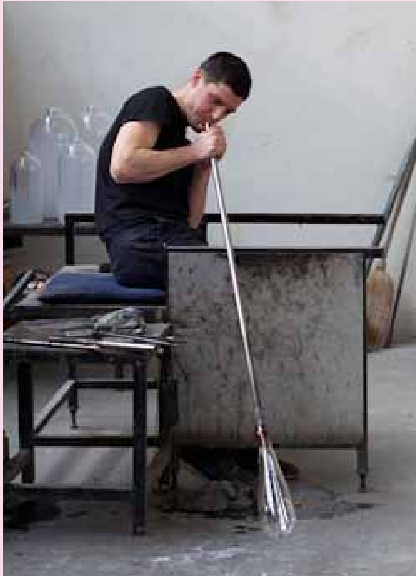
3 Mit dem Blasen entsteht Volumen.
