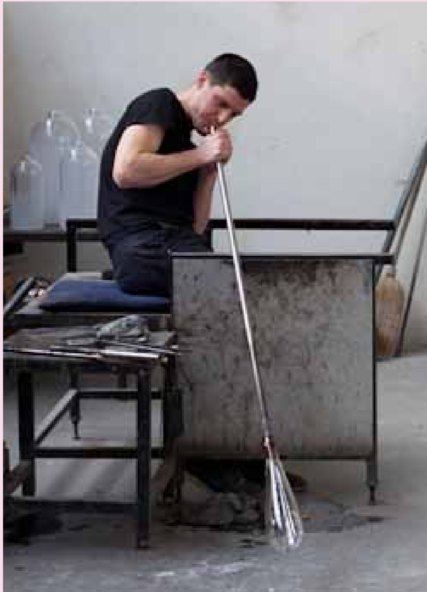
3 Mit dem Blasen entsteht Volumen.
