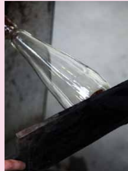
6 Der Boden wird mit einem Holzspachtel angedrückt.
